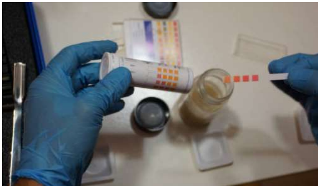
Badania soli w próbkach pobranych podczas oględzin obiektu
